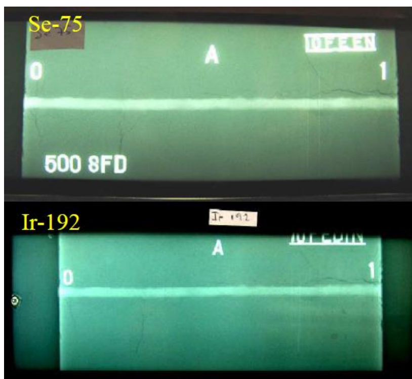
圖 9：Se-75 射源與 Ir-192 射源對於裂紋的靈敏度比較[9]
