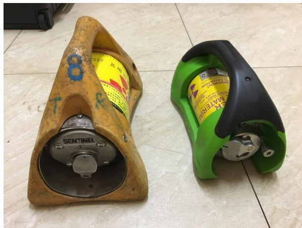
圖 10：Se-75 射源的屏體(右)與 Ir-192 射源的屏體(左)
