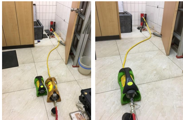
圖 13：分別以兩個射源進行檢測(左圖為 Ir-192 射源；右圖為 Se-75 射源)
