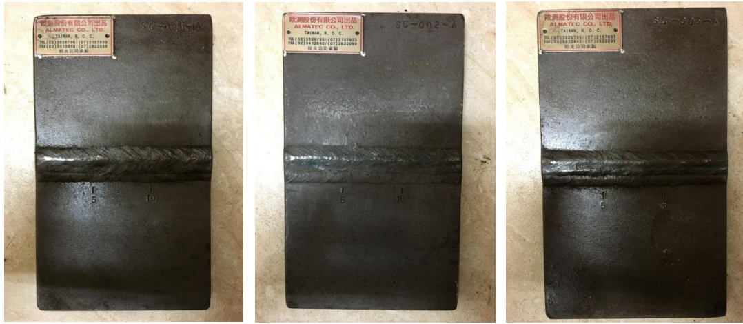
圖 12：實驗測試用對接平板銲道試片 (共三塊，由左而右分別為 SC001A、SC002A、SC003A，板厚 18mm+銲冠高 2mm)
