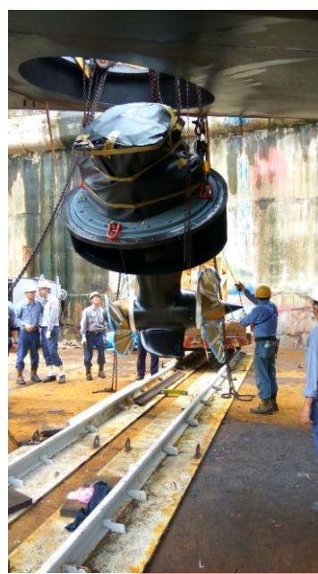
利用四部鍊滑車調整 SRP 水平面，並將 SRP 向上吊至定位。
