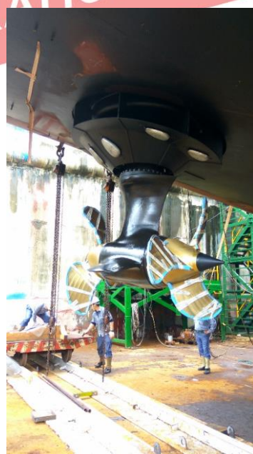
利用四部鍊滑車調整 SRP 水平面，並將 SRP 向上吊至定位。
