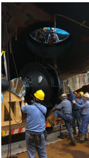
利用四部鍊滑車調整 SRP 水平面，並將 SRP 向上吊至定位。
