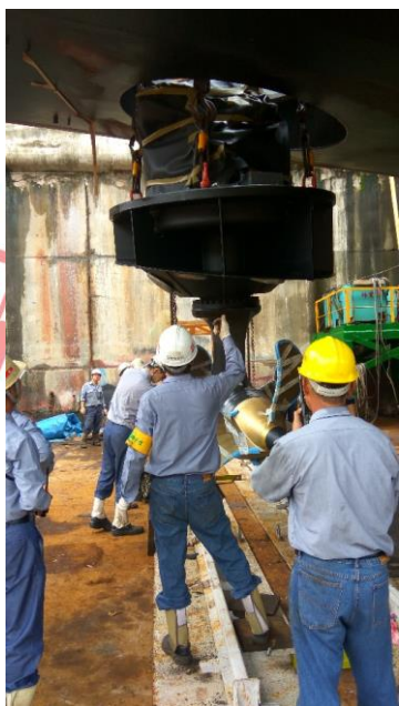
待螺絲鎖上後，脫鉤完成吊裝程序。
