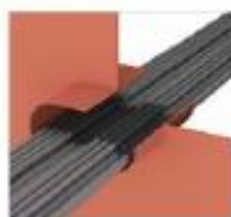
步骤②： 将不同规格HK-G膨胀防火套管 预置在相对热的电缆上，使电缆之 间的距离大于5mm。
