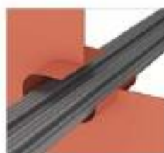
步骤①： 清洁电缆表面及护套内壁。
