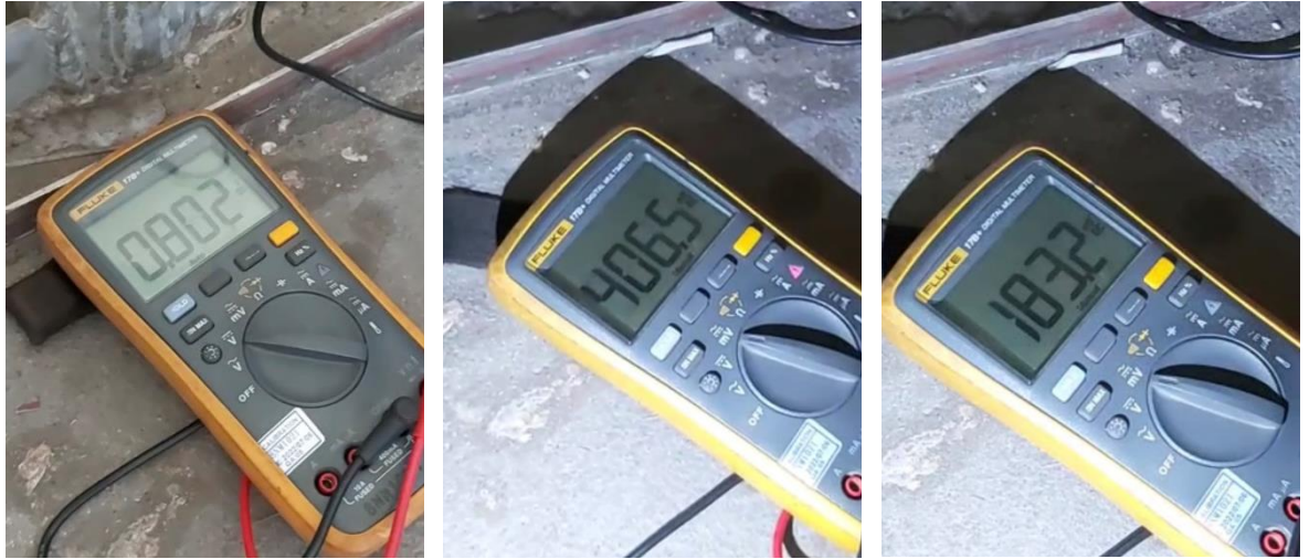
圖 2-13 施工時貫穿件與電纜間電壓變化
