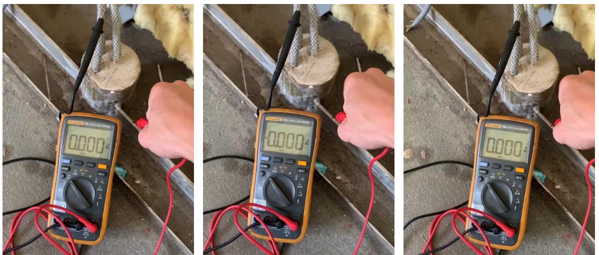
圖 2-14 收工時貫穿件與電纜間電壓變化
