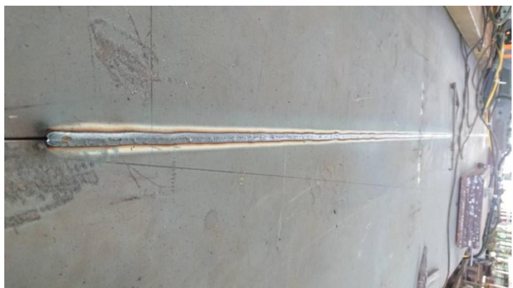
↑ 板厚 3mm、GAP2mm、鉚冠 1mm、鉚寬 7mm
