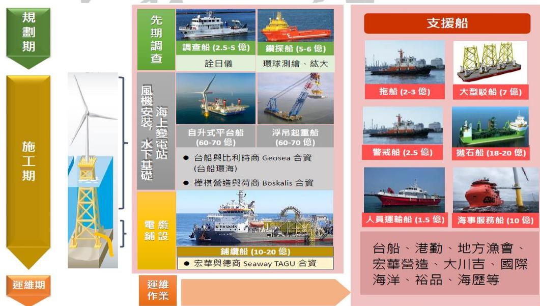
(圖二:離岸風電工作船機)
