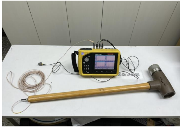
圖. FRF 量測設備
