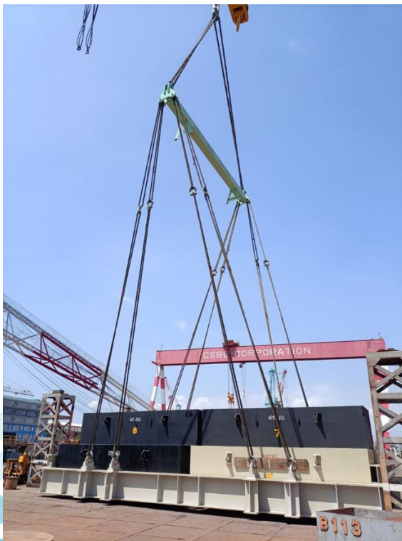
吊桿實際測試
