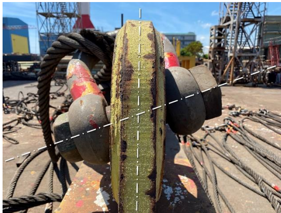
單片式吊環設計卸扣容易歪斜
