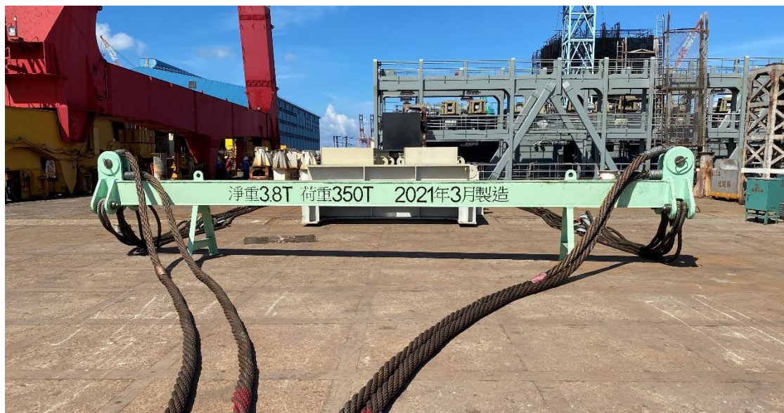
新型式輕量化的吊桿 9 米長，荷重 350 噸，淨重 3.8 公噸
