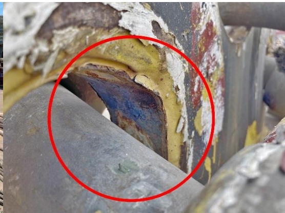
歪斜的卸扣容易產生眼孔磨損
