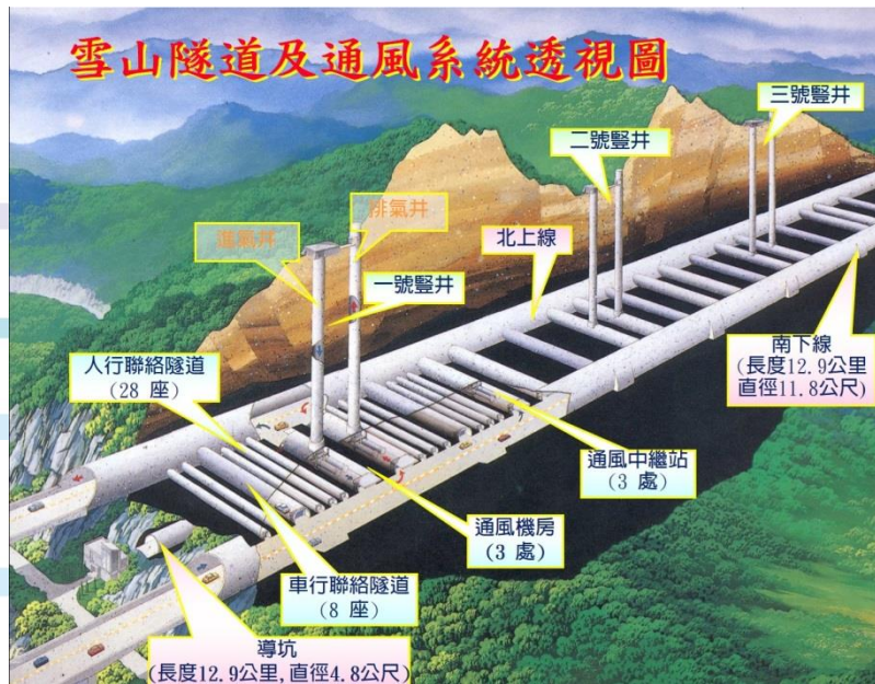
圖二 雪山隧道及通風系統透視圖
