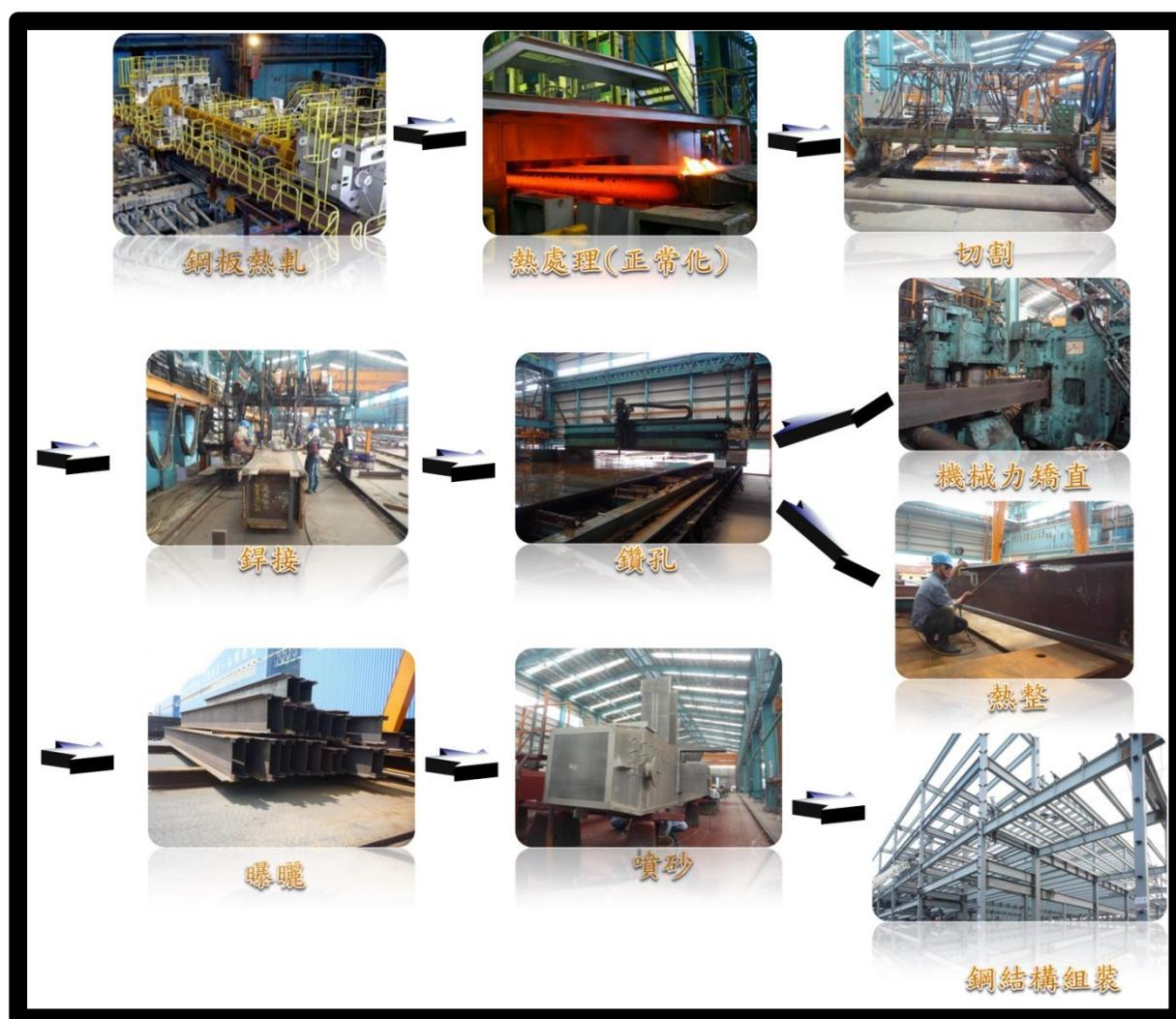
圖一 鋼構結構製程導入殘留應力
