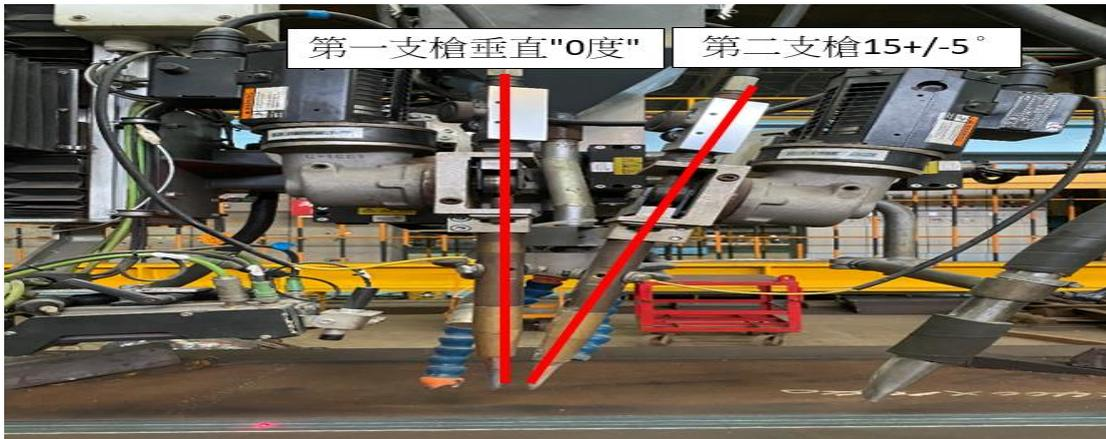
圖四. 鉸槍角度調整狀況及示意圖(來源:技術課提供)
