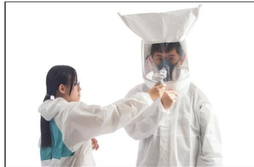
圖 3: 半面體呼吸防護具之定性密合度測試
