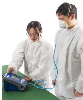
圖 4: 以儀器量測方法進行 N95 之定量密合度測試
