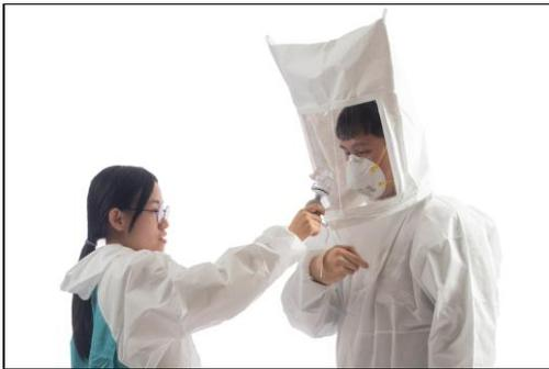
圖 2: 過濾面體式口罩之定性密合度測試
