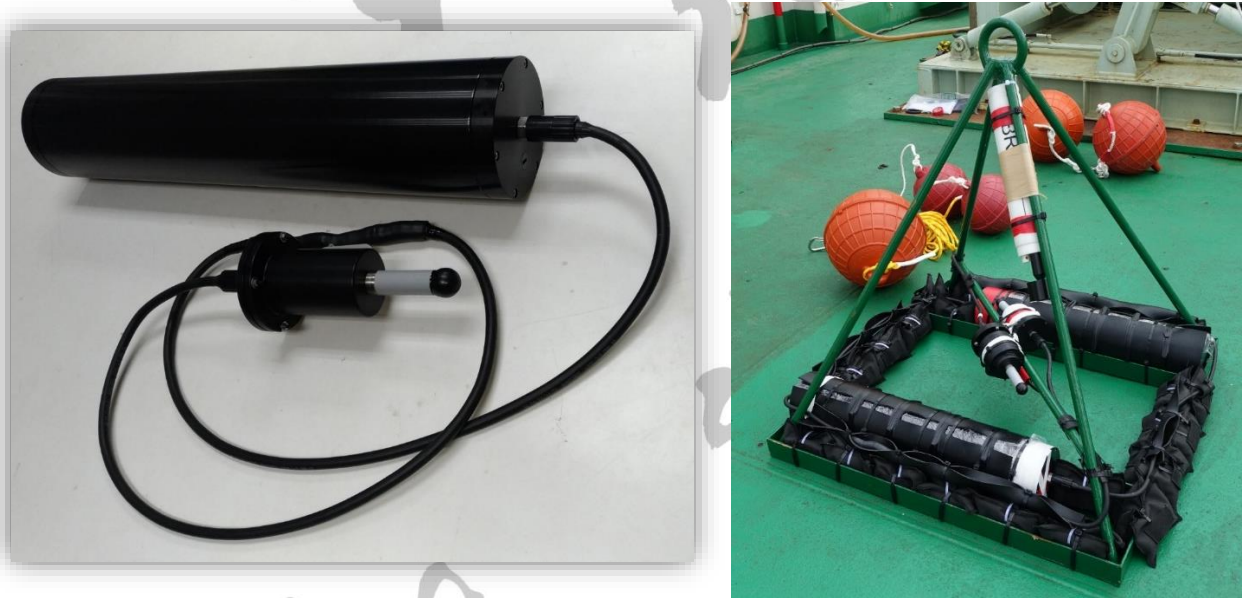
圖-4 左：水聽器 Auspice HN1(Awareocean)。右：底錠式資料量測器具
