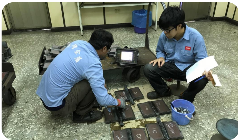
委託外部檢測單位進行電銲成品檢測
