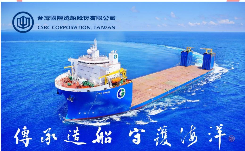
台船公司繼 1999 年建造當時全球噸位最大的「黑馬林魚(Black Marlin)」及「藍馬林魚(Blue Marlin)」56,500 載重噸潛舉式重載輪後，更高技術規格之突破，不但載重噸位更大、符合極地冰區航行要求，甚至續航力達 25,000 海浬，可繞行地球一圈！
