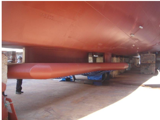
圖 8. 吊艙 Gondola 方式安裝聲納設備
