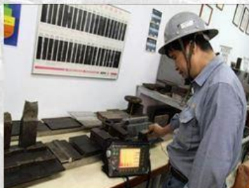
非破壞檢測-超音波檢測
