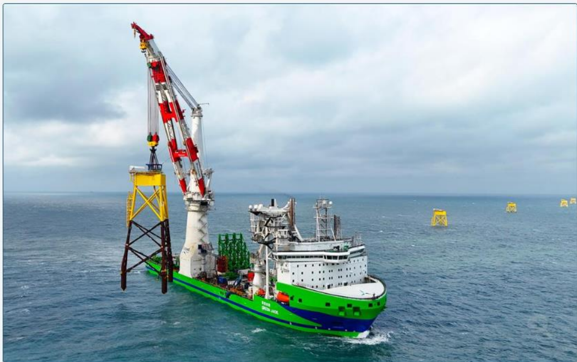
台船環海旗下環海翡翠輪曾執行中能離岸風場水下基礎運輸與安裝作業。圖 / 台船提供
