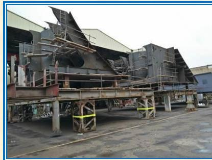
現今因艤品、料件不順，造成許多船段在艤品或內業完檢後，馬上搬運進噴砂塗裝，塗裝完檢後基本上安裝會直接吊裝，在中間幾乎不留時間給搭架工程施作，吾人在此時必須介入流程裡，至少在吊裝協調會上將需要的施工時間押下，若可以的話要在每天中午時，與大吊車排車領班直接協調，避免沒搭架的船段直接吊裝。謹記，船上搭架至少是地上搭架的3倍工時以上。
