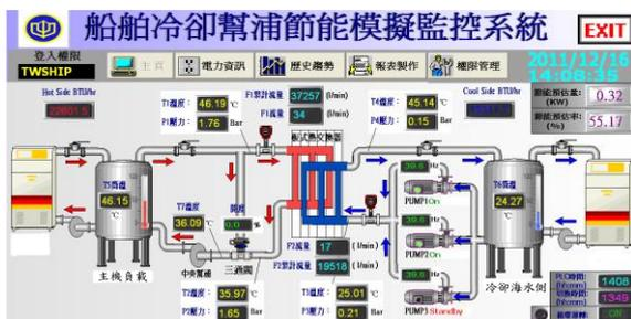
中央冷卻海水泵變頻節能控制系統
