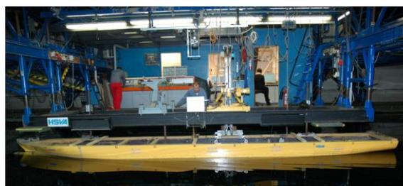
8,000 TEU 貨櫃輪在 HSVA 之船模自航試驗，於設計船速時之興波非常平緩，顯示船舶阻力性能良好
