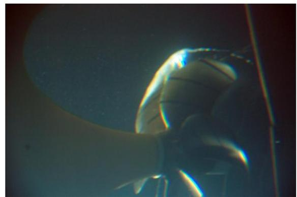
該試驗亦正式邀請船東陽明海運公司參加見證，船廠、船東與試驗水槽的互動與討論十分熱烈，為國內產學研用的結合，豎立新的里程碑。新螺槳的模型試驗結果相當成功，預計可以為實船提升 4.4% 的推進效率，讓設計船速提升 0.25 節。估計每艘 8250TEU 貨櫃輪在每一年即可省下 160 萬美元的燃油費用，不但能降低船東的營運成本，也展現出船廠與船東對於節能減碳的努力。
