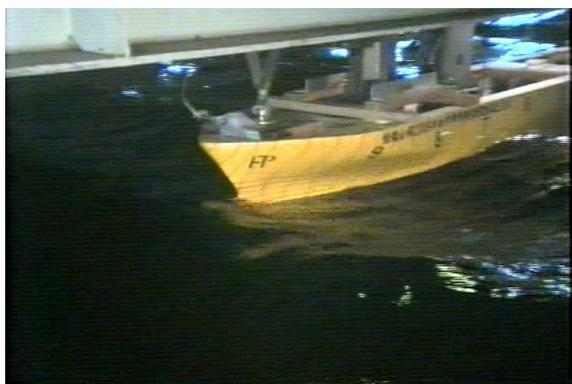
從原型船的試驗量測資料可以發現波浪對船舶阻力和運動所造成的反應，同時亦可觀察到波浪對吃水線以上的船體結構影響。因此下一階段的試驗將加入壓力量測，所獲得的資料將應用於船舶結構設計研發，用以評估波浪作用力及分析結構之動態反應。
